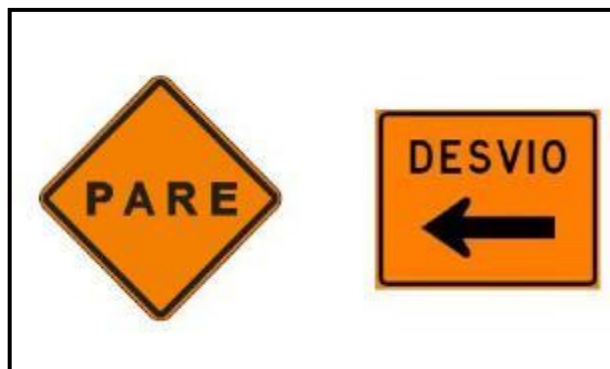
Figura 60 – Exemplo de placas de sinalização vertical de advertência (obras).
