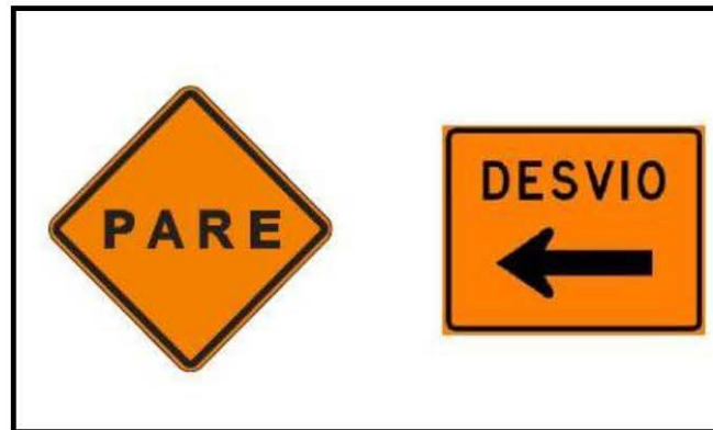
Figura 55 – Exemplo de placas de sinalização de obra.
