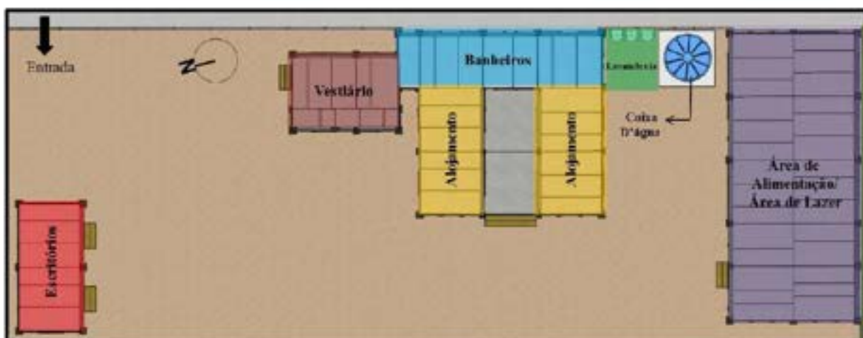
Figura 161 – Planta baixa de um canteiro de obra.
