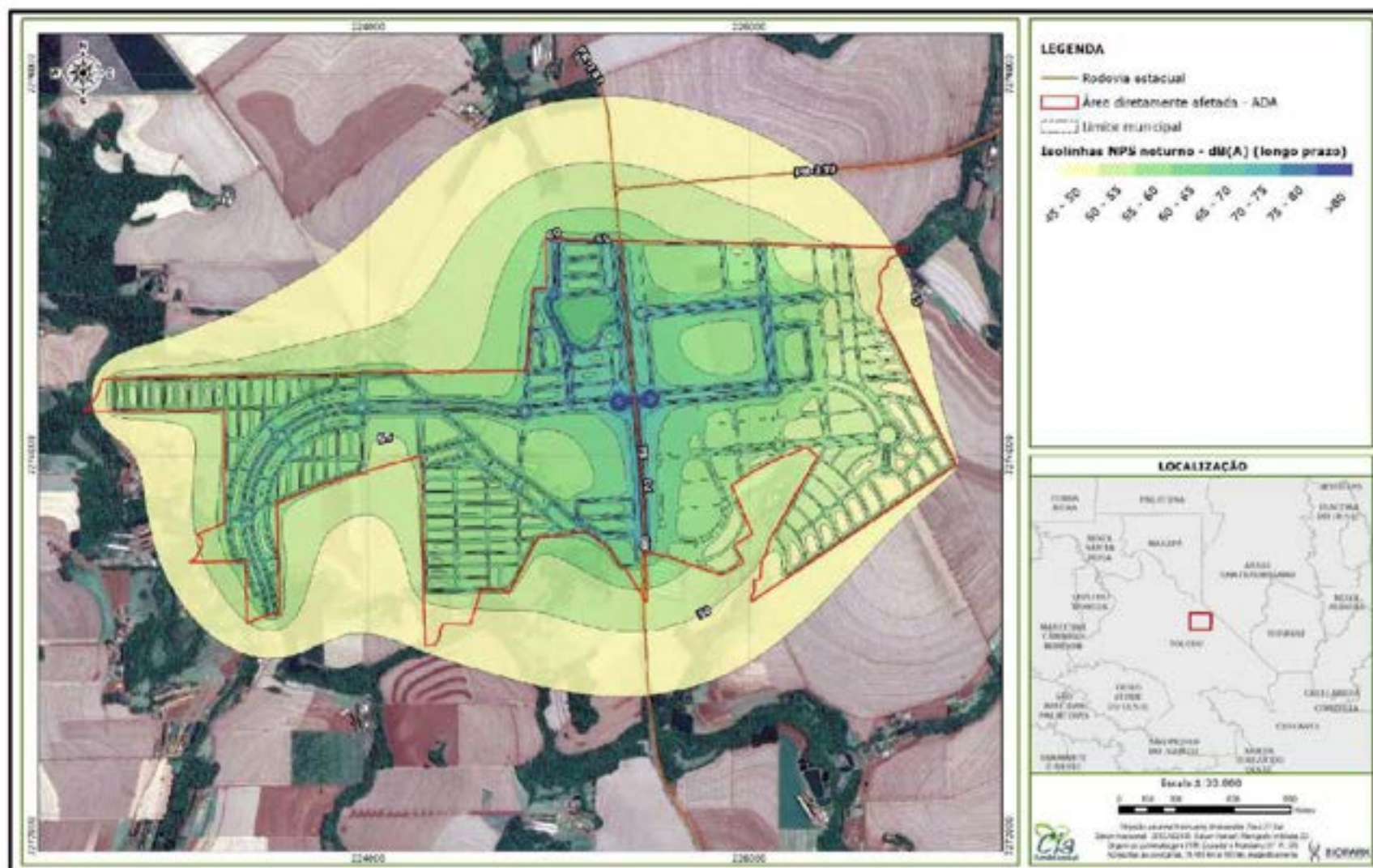
Figura 176 – Mapa de isolinhas a cada 5 dB(A) da condição de máxima ocupação do Biopark no período noturno a longo prazo.
